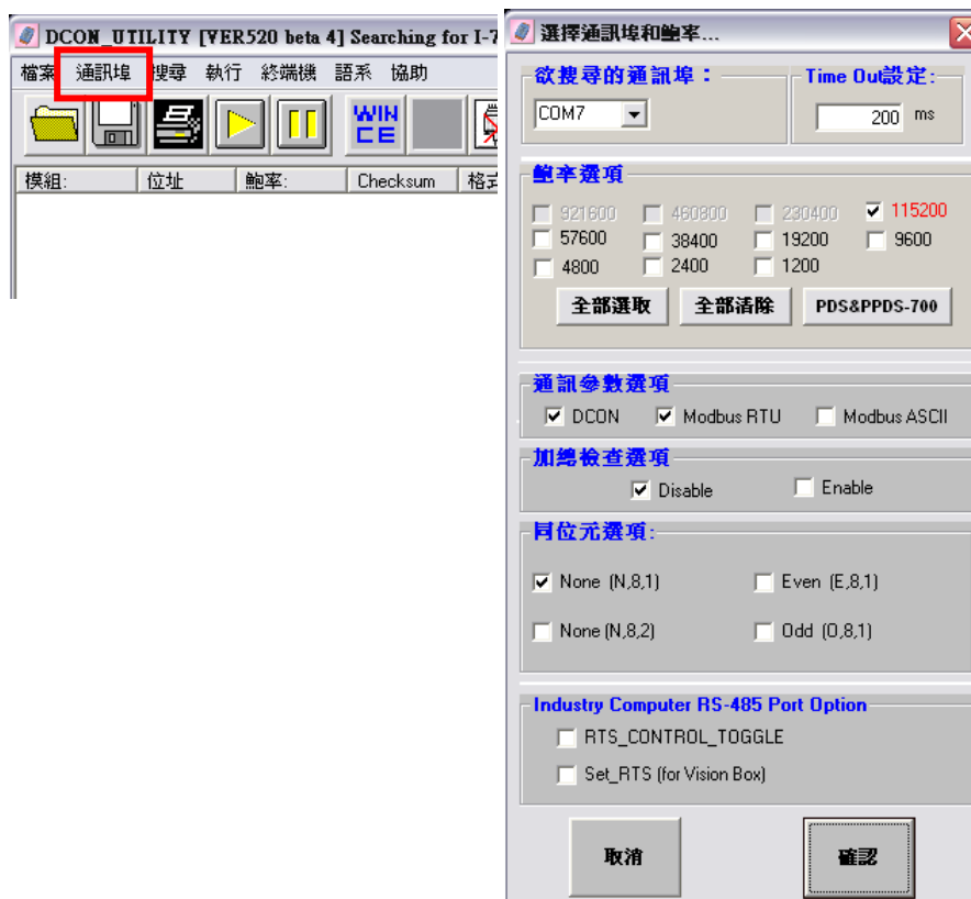
圖 2-6：檢查 COM Port、Baudrate 與 DCON Protocol 設定
